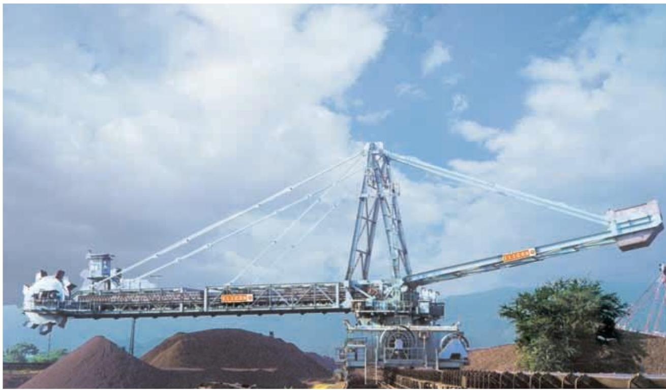
Роторный стреловой рекаймер с длиной стрелы 40 метров и производительностью 4000 тонн/час, используемый для перевалки железной руды в порту Vizag
