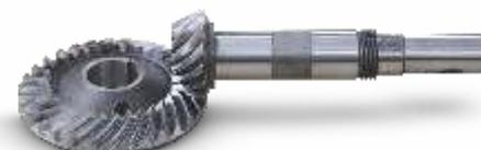
**30. КОНИЧЕСКАЯ ПЕРЕДАЧА С КРУГОВЫМ ЗУБОМ – ЧИСТОВАЯ РЕЗКА ТВЕРДЫМ ИНСТРУМЕНТОМ**
